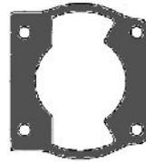
ガスケットの角（2箇所）がクランクケースの合い面より外側に出るようになります。
